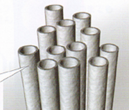
中空糸膜フィルタ構造・拡大写真
